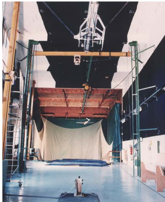
Fig. 71 Essai de perte de contrôle à la catapulte B5 de l'IMFL. La maquette catapultée est visible au centre
