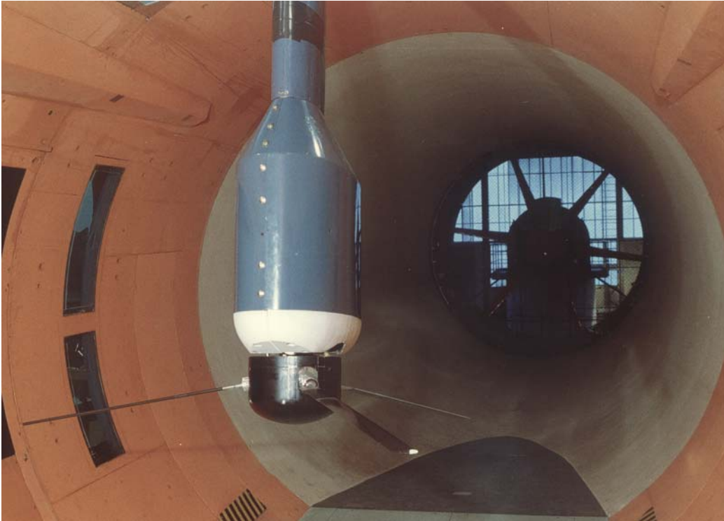
Fig. 11 Banc d'essais dynamiques de rotors dans la soufflerie S2Ch de Meudon
