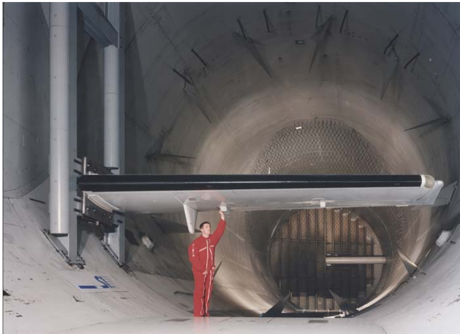
Fig. 31 Essai de givrage sur une aile d'ATR 72 dans la soufflerie S1MA de Modane
