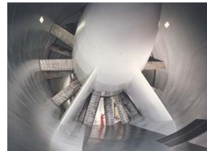
Ventilateurs ( \text{Ø} = 15 \text{ m} , 88 MW)
