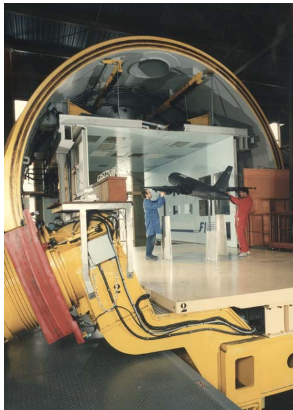
Fig. 55 Préparation d'un essai sur maquette Airbus dans l'un des chariots de la soufflerie F1 du Fauga
