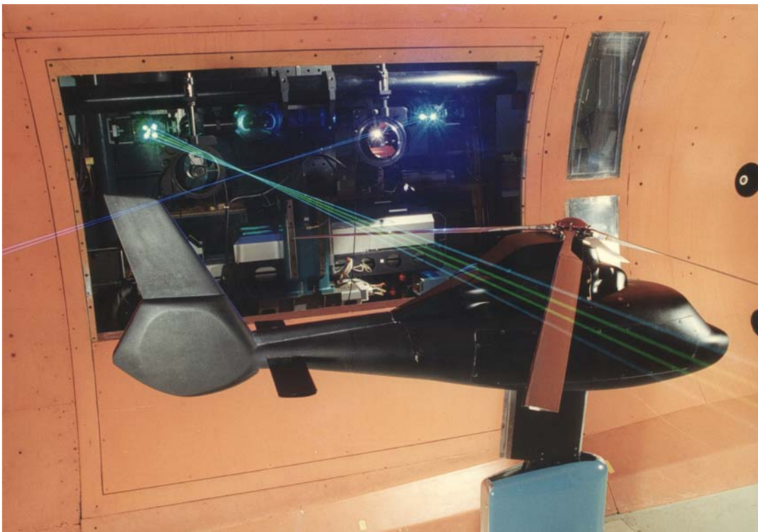
Fig. 12 Etude par vélocimétrie laser de l'écoulement aérodynamique autour d'une maquette d'hélicoptère Dauphin dans la soufflerie S2Ch de Meudon
