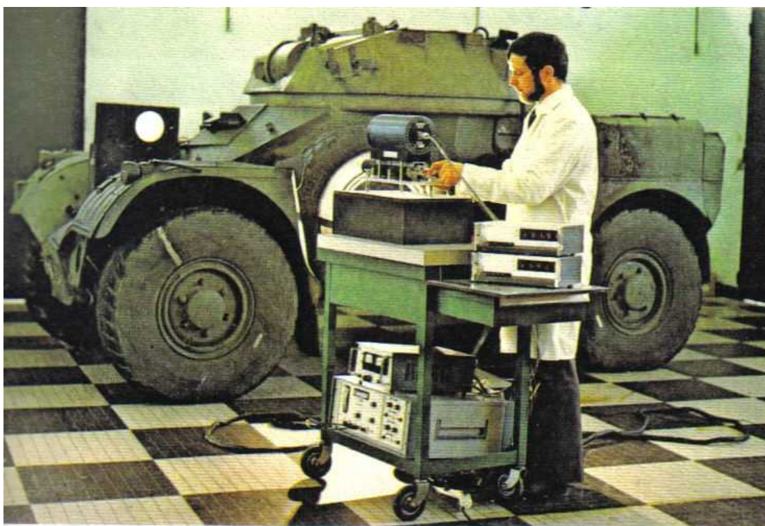
Fig. 4 Mise au point d'un appareillage de mesures accélérométriques et vélocimétriques sur un engin blindé léger, avant son départ pour le tunnel de Sauclières
