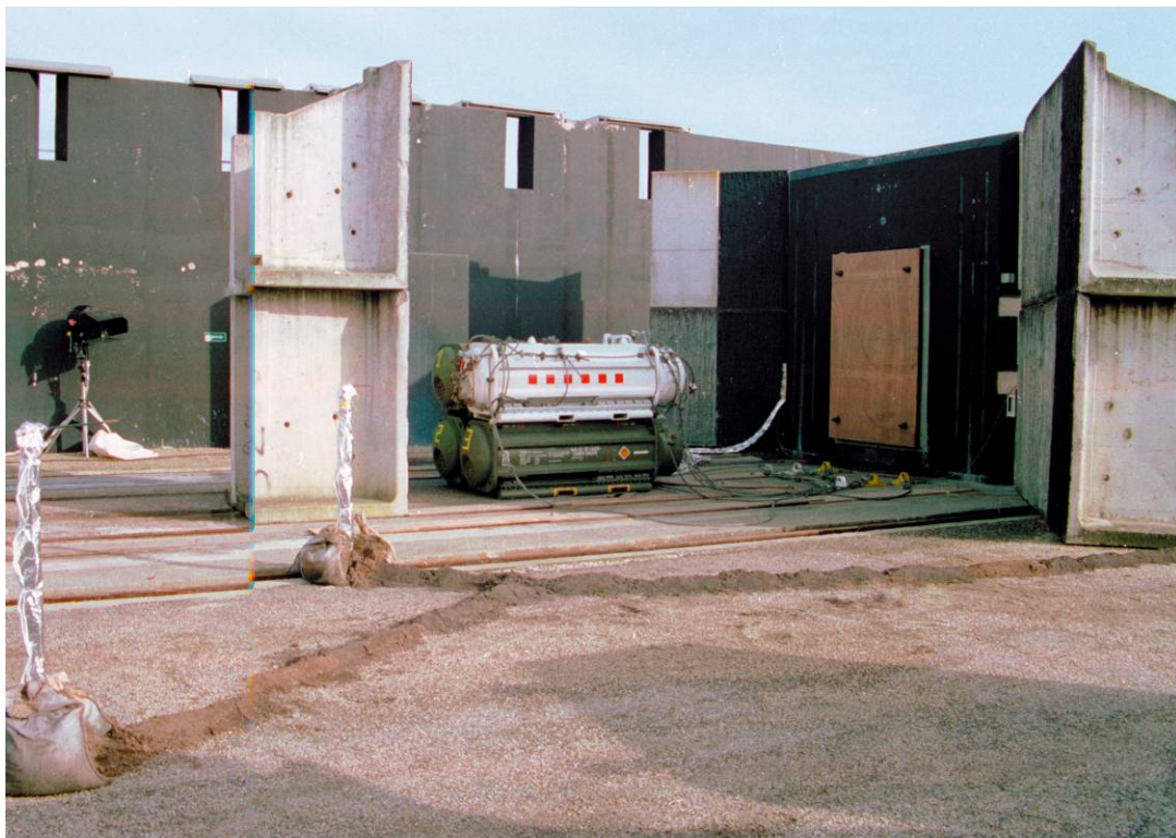
Fig. 10 1994, groupe de quatre conteneurs, dont l'un contient un missile AS30 que l'on mettra à feu pour évaluer l'éventuelle propagation de phénomènes pyrotechniques à ses voisins
