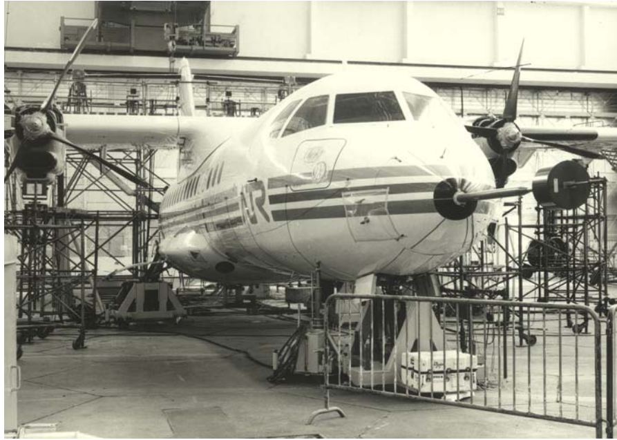
Fig. 78 Essai de vibration au sol de l'ATR42 par l'ONERA
