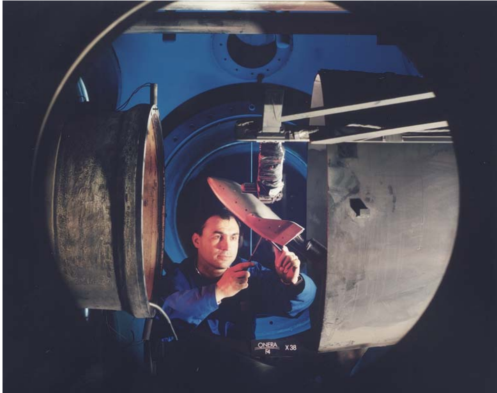
Fig. 63 Essai d'une maquette X38 à l'échelle 1/24 pour des mesures d'efforts, dans la soufflerie F4 du Fauga
