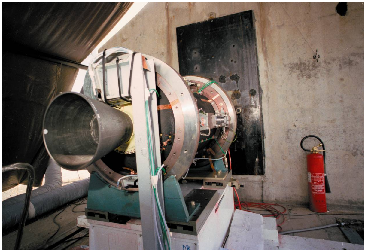
Fig. 8 1986, premier tir d'un propulseur nitralane en structure carbone, sur un banc d'essais implanté sur un site du CEL à Captieux
