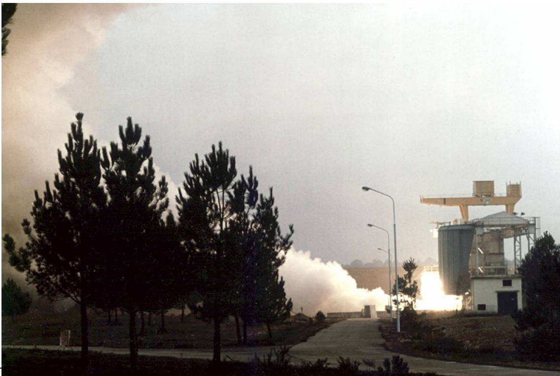
Fig. 2 1976, essai d'un propulseur en ligne de vol, tuyères vers le bas
