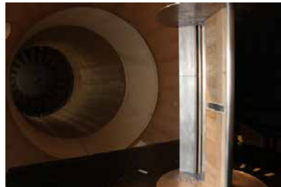
Profil d'aile d'Alérion M1h dans la soufflerie Eiffel
