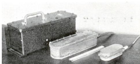
Fig. 3 Trois boîtiers d'accélérographe Ch. Beaudouin, dont les masses varient de 4 kg à 250 g, comparés à une règle à calcul
