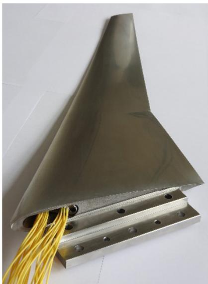
Figure 13. Aile d'envergure 600 mm, réalisée par fabrication additive métallique dans le cadre du projet MATRIS3D – l'équipement en prises de pression est ici intégré à la matière
