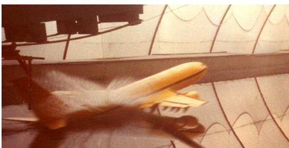
Amerrissage d'une maquette d'Airbus.
