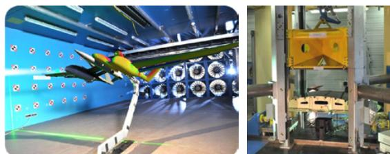
*Maquette de drone pour lanceurs aéroportés (Eole) dans la soufflerie L2 (à gauche) – Essais de crash d'un fond de barque de fuselage composite (à droite)*
