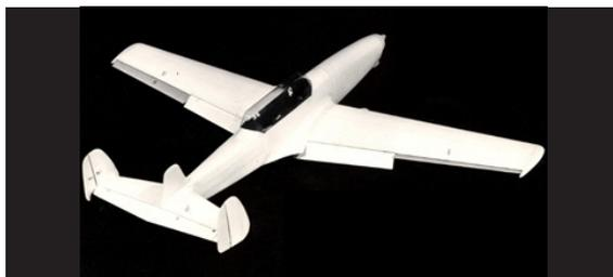
Maquette d'un avion suisse, le C3605 (C3603 avec turbopropulseur).
