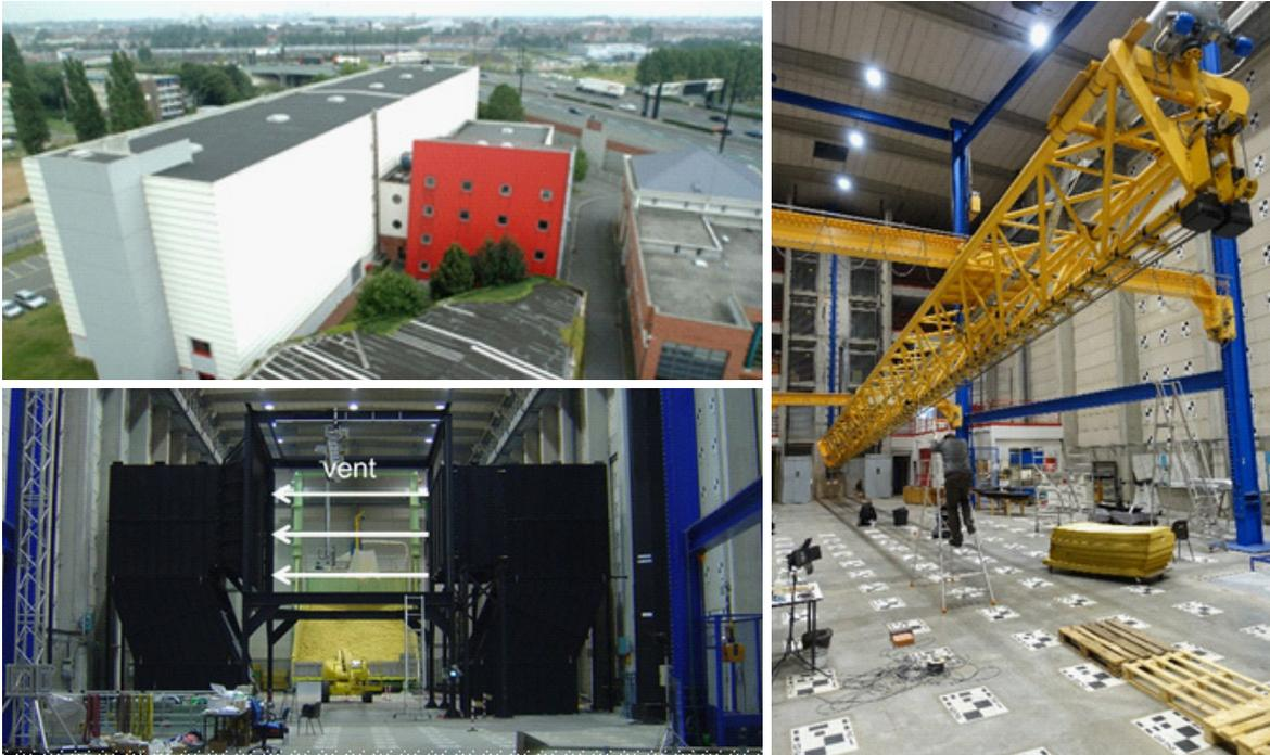
Figure 4. Vue extérieure du bâtiment B20, de la catapulte de lancement pour essais d'impact de drones et du générateur de rafale pour essais d'aérodynamique
