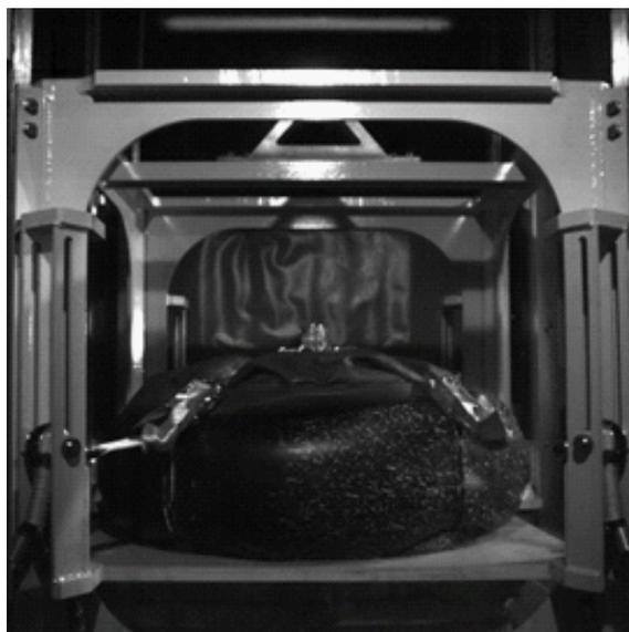
Figure 5. Essais de crash de réservoirs souples d'hélicoptères avant impact à gauche et au cours de l'impact à droite.
