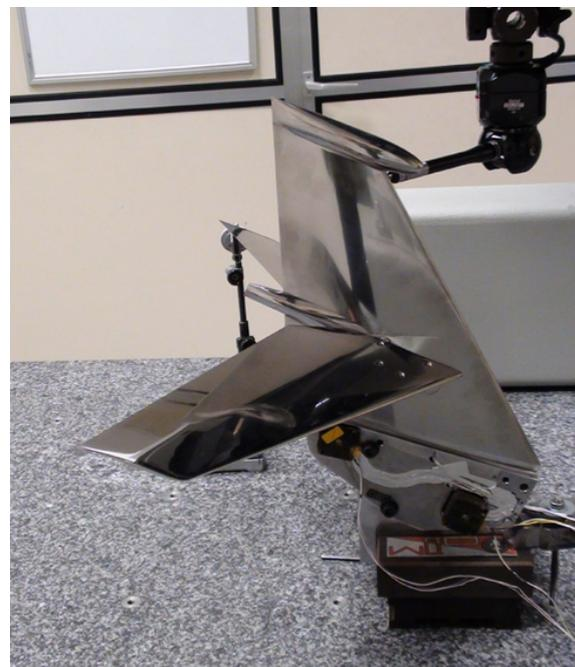
Figure 6. Motorisation d'empennage pour essais en conditions cryogéniques sur maquette de Falcon Générique – sur la photo, le dispositif est en cours de contrôle sur machine à mesurer tridimensionnelle – chaque calage, une fois verrouillé, est mesuré avant intégration du sous-ensemble dans le fuselage de la maquette
