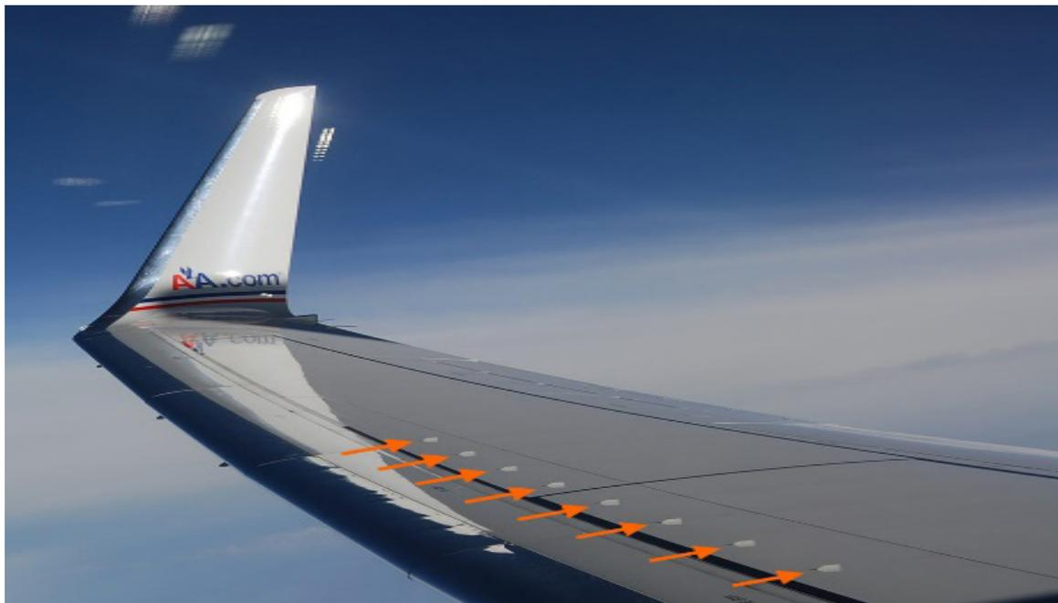
Figure 1. Exemple de générateur de vortex sur B737-800
