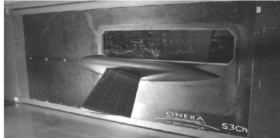
Figure 9. Voilure+demi fuselage monté en paroi de la soufflerie S3Ch du centre ONERA de Meudon. Demi-envergure 0,7 m (extrait de [1]-01)
