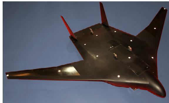
Figure 3. Maquette de vol libre VELA 1 réalisée en composite, bois, mousse et aluminium, et testée sur la catapulte du laboratoire B20 du centre ONERA de Lille. On peut noter la trappe centrale d'accès au rack d'équipement embarqué.
