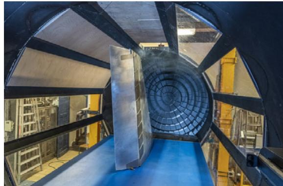
Figure 4. Maquette de dérive d'avion dans la soufflerie L1 du centre ONERA de Lille. On distingue les 8 jets balayants positionnés en amont de la gouverne
