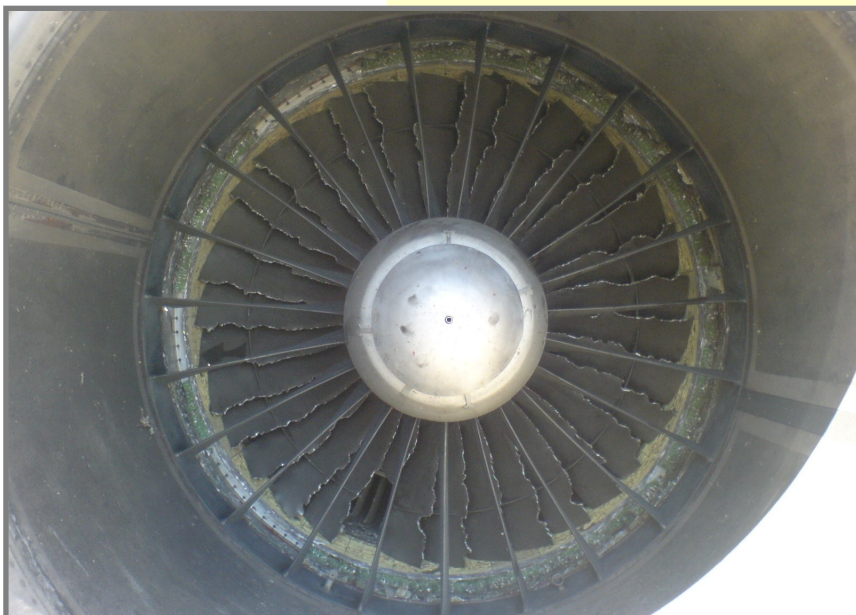
Vue des ailettes d'un turboréacteur Pratt & Whitney JT8D après l'impact d'un oiseau, via wikimedia commons .
