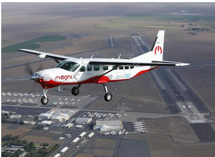
Fig 25 - Cessna 208 Caravan équipé de moteur électrique- MAGNIX
