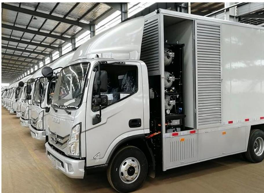
Fig 24 - Camions alimentés par des piles à combustibles - HorizonFuelCell
