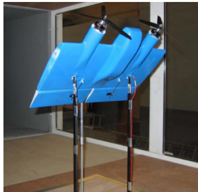
Figure 27 – Veine d'essai avec la maquette du MAVion à l'échelle un.
