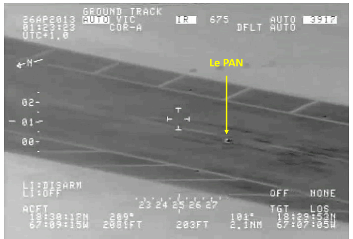
Fig. 7 – Sur l’image de gauche, la distance target est 6300 m, la taille calculée est 1,2 m – Pour 3900 m (image de droite), la taille est 1,3 m, confirmée par comparaison avec la largeur (45 m) de la bande centrale de la piste – la taille maximale est celle d’un objet proche du target c’est à dire proche du sol.
