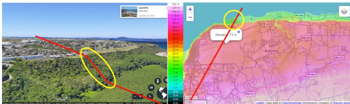
Fig. 14 – La forte déclivité du terrain au passage de la côte provoque l'important changement de position du point visé par la caméra et donc de la distance laser
