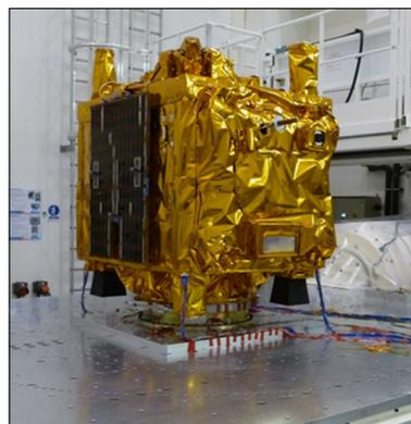
Satellite en configuration de vol pour essais de vibrations
