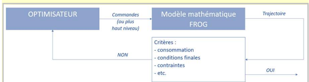
Fig. 4 - Principe d'optimisation d'une trajectoire de référence.
