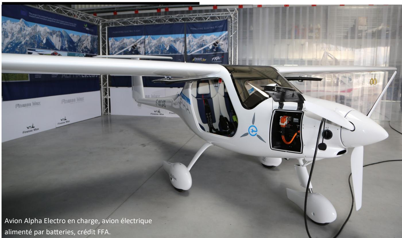
Avion Alpha Electro en charge, avion électrique alimenté par batteries, crédit FFA.
