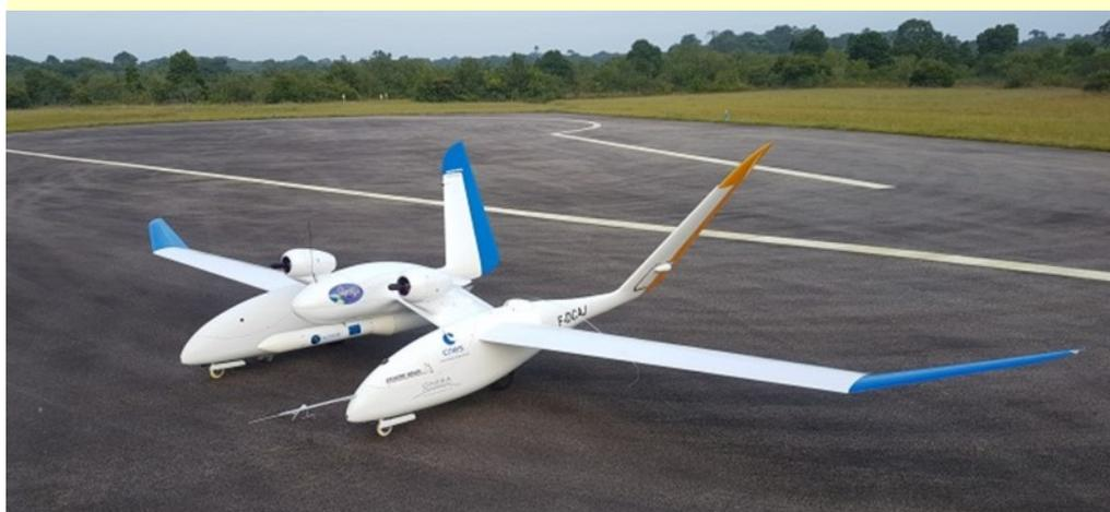
Fig. 4 - Démonstrateur EOLE équipé de la maquette de lanceur ALTAIR.
