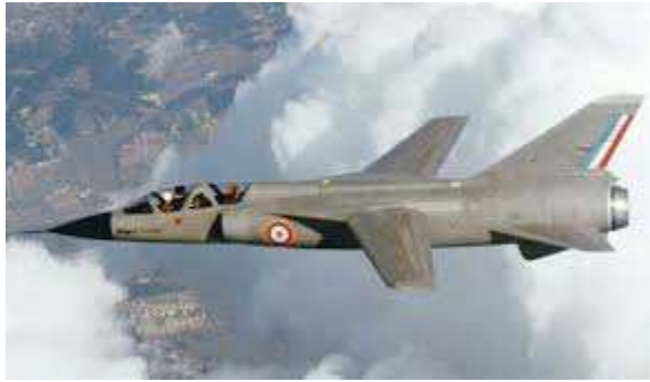
Dassault Mirage III G 01 en configuration lisse, flèche à 16 degrés
