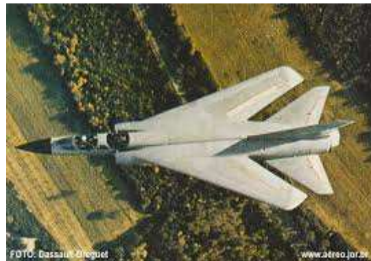
Dassault Mirage III G 01, flèche à 72 degrés
