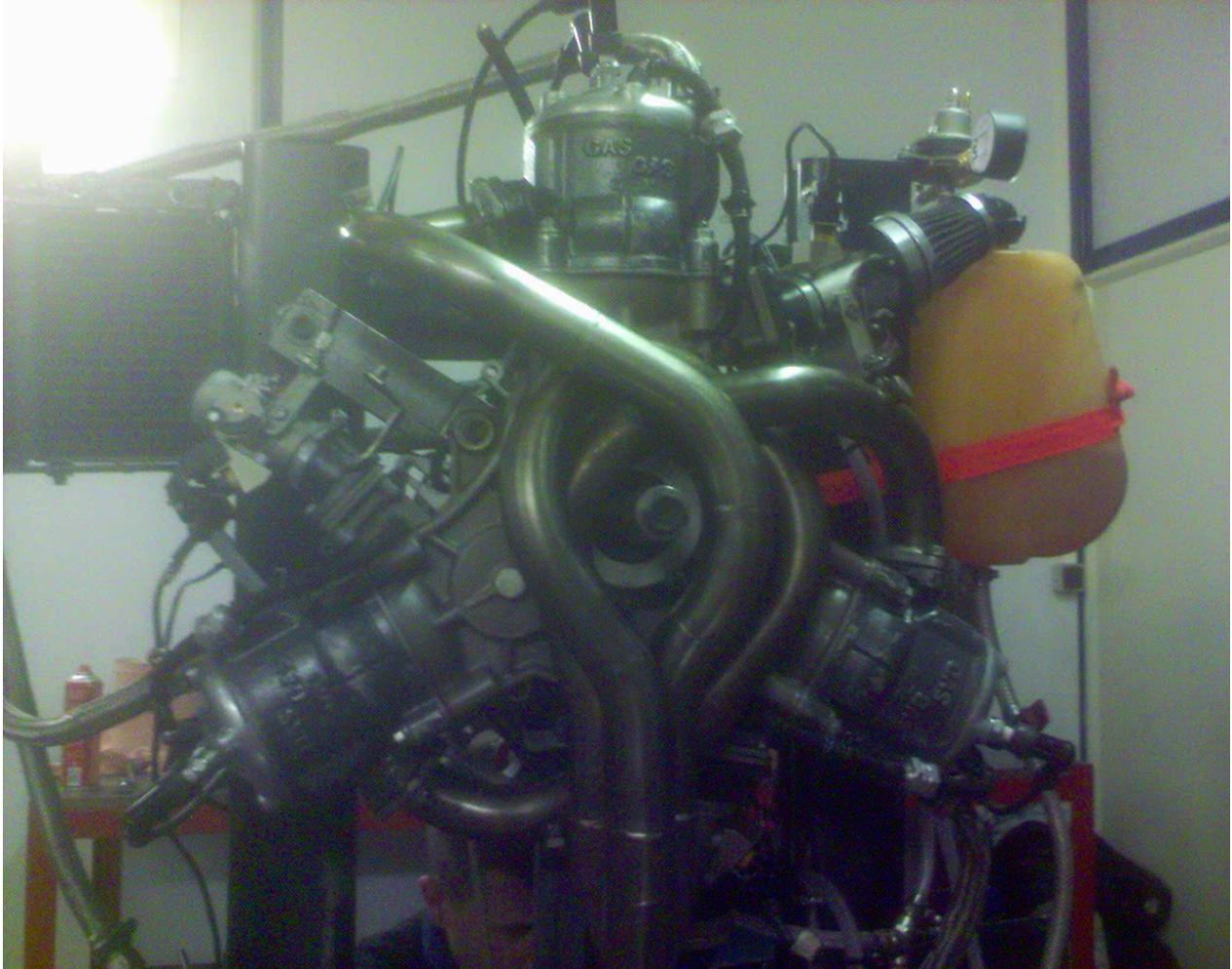
**Le tri-moteurs indépendants à injection indirecte. Essais SODEMO;2008 ;**
