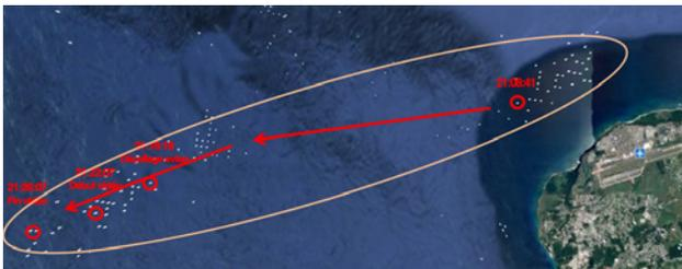
Figure 4 – Positions successives de l'écho qui a alerté les contrôleurs avec une dérive des plots vers l'Ouest
