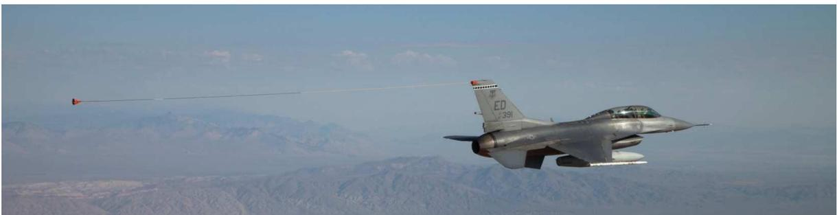
Méthodes évaluées : passages tour, accélérations/décélérations en palier, trèfles à 6 branches (se révélant peu adaptés pour les avions rapides), virages sur 360°, avec utilisation d'un modèle d'atmosphère recalé par mesures sur lâchers ballon (PS, TS mesurées tous les 100 ft).
