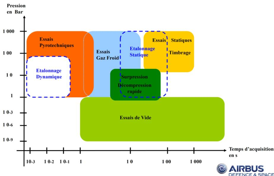
Zoom sur les mesures de pression dans les essais pyrotechniques : gammes de pression des essais pyrotechniques : 1 à 1000 bars, temps d'acquisition de 1ms à 1000ms avec des fréquences d'acquisition de quelques MHz. Calibration statique et dynamique.
