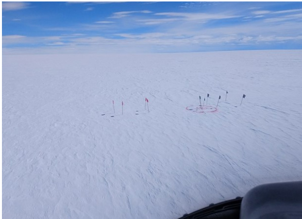
Fig. 16 Maximum de détection TEM (fanions et cercle rouges) et bords des crevasses voisines (fanions noirs). photo : Thue Bording (Université d'Aarhus)
