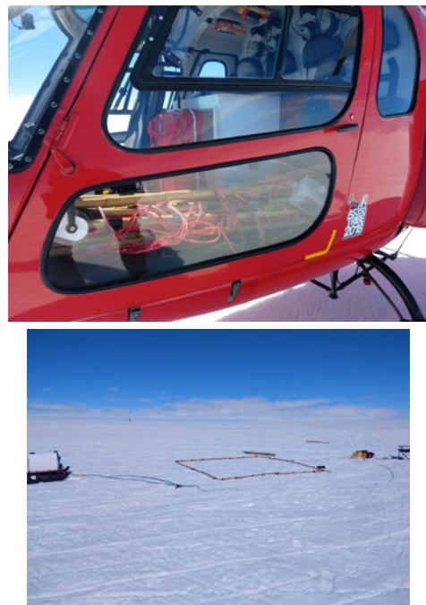
Fig. 15 Détecteur TEM simplifié dans un hélicoptère (gauche) et déployé à la position du candidat no 1 (droite). La bobine d'émission est maintenue en place par des tiges de bambou et du ruban adhésif. photo : Thue Bording Université d'Aarhus
