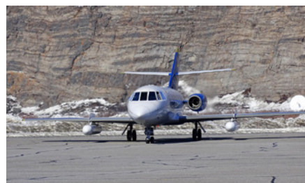
Fig. 4 Le système SETHI dans la configuration utilisée au Groenland, l'antenne UHF est sous l'aile gauche (visée vers la gauche). Les antennes X et L sont sous l'aile droite (visant respectivement vers la droite et la gauche).
