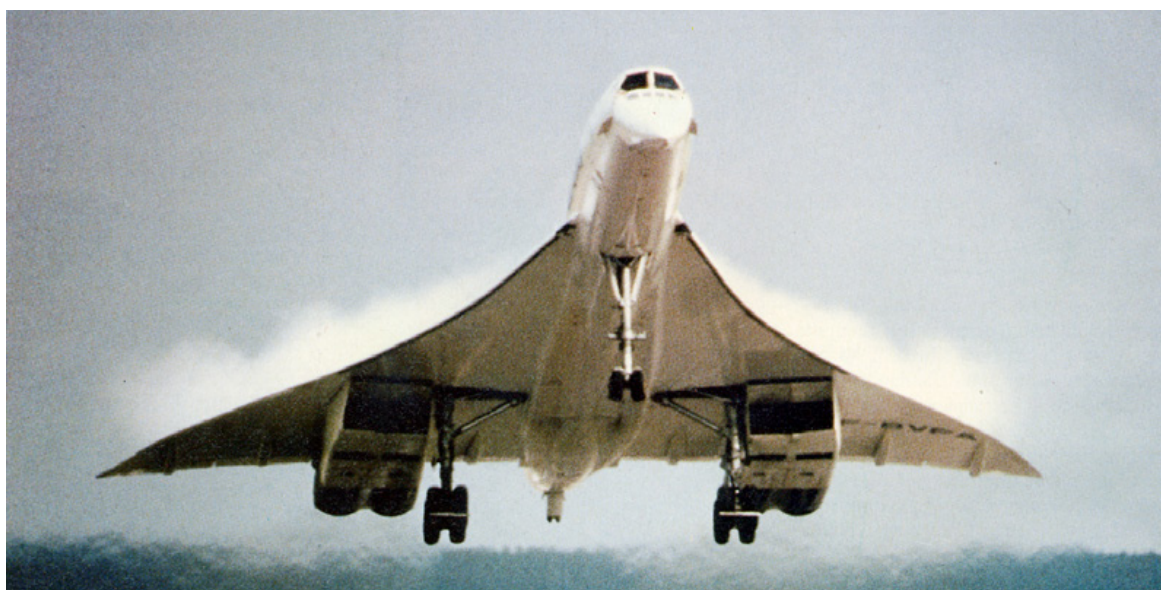
Figure 1. Concorde au décollage montrant la disposition des prises d'air
