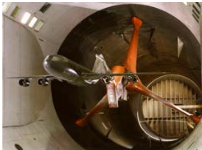
Fig. 2 - Essais de l'Airbus A380, soufflerie S1 de Modane.
