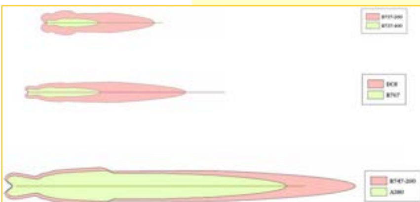
Fig. 3 - Évolution du bruit à la source (iso contours dB) entre 1955 et 2015.
