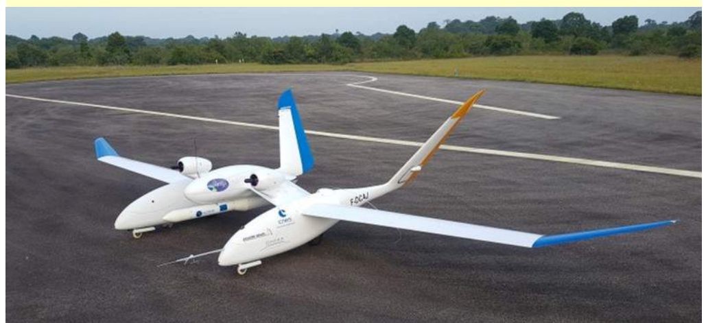
Fig. 4 - Démonstrateur EOLE équipé de la maquette de lanceur ALTAIR.
