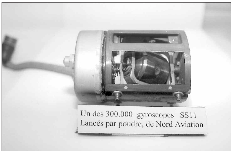
Un des 300 000 gyroscopes SS11 lancés par poudre, de Nord Aviation (1950-1960). Cet appareil est aussi le gyroscope de sécurité de l'Exocet.
