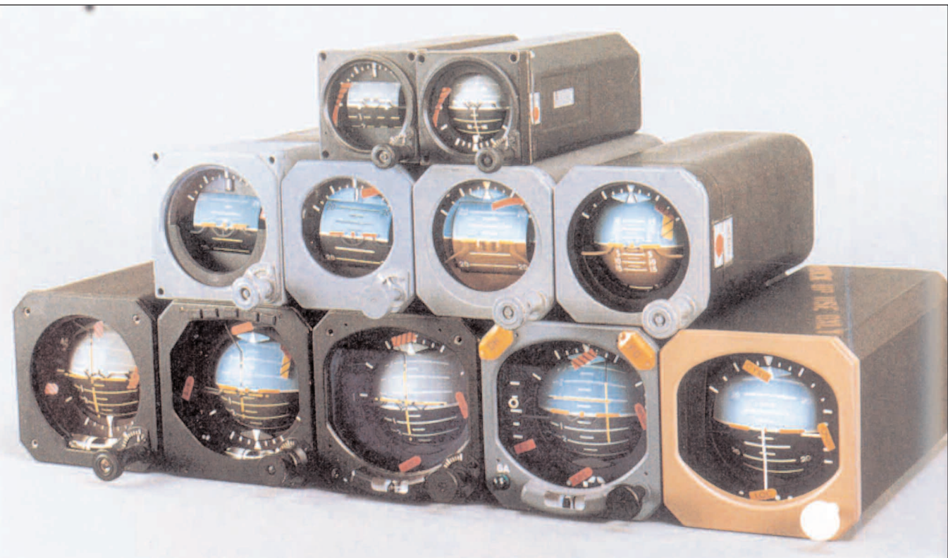
Différents types d'horizons gyroscopiques SFENA (Source GIFAS).
