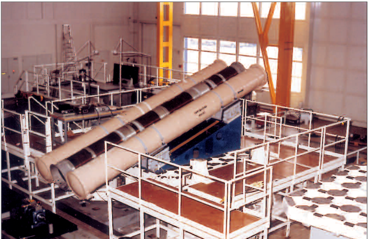
SOPEMEA Villacoublay – Essais d'un missile aux vibrations
