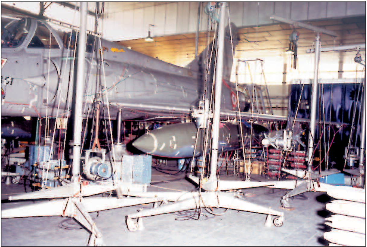
SOPEMEA Villacoublay – Analyse modale du Mirage.
