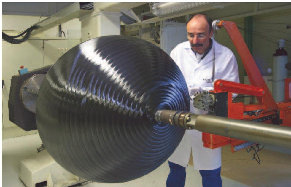
*Opération de bobinage d'une sphère haute pression (Avec l'aimable autorisation d'Astrium)*
