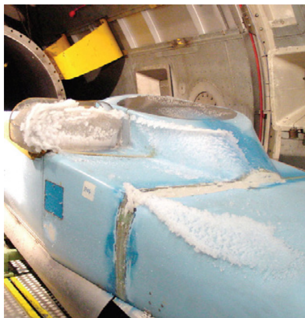
Figure 8 : Essai de givrage sur une entrée d'air d'hélicoptère au banc R6
