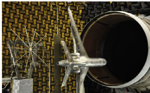
Antenne 2D composée de 10 bras et de 115 microphones, installée dans la soufflerie anéchoïque CEPRA19 de l'ONERA
