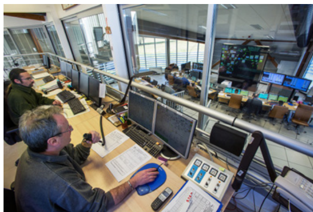
Figure 4 : Supervision d'essais en cabine de pilotage de l'ensemble des réseaux d'atmosphérisation alimentant les bancs d'essais. C'est la "tour de contrôle" pour la coordination des essais
